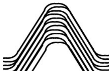
② 完全同期+テンション・コンプレッションホルダ環境での切削イメージ
