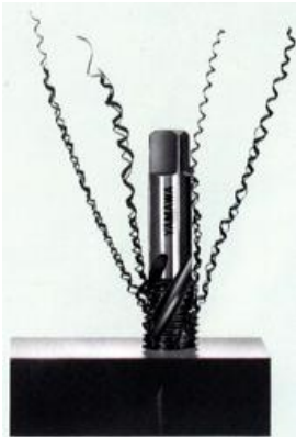
スパイラルタップの切りくずの排出モデル
