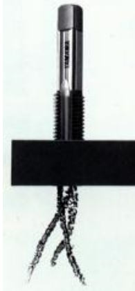
ポイントタップの切りくずの排出モデル
