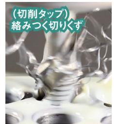
◆ロールタップ採用により切りくずトラブルの悩み解消!
