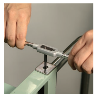
タップハンドルを用いての手回し加工
