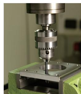
ボール盤での機械加工
