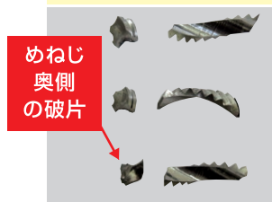
除去されたタップの破片
