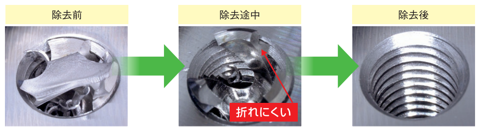
除去されたタップの破片
