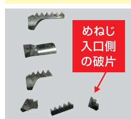
除去されたタップの破片
