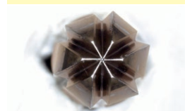
除去されたタップの破片
