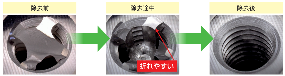
除去されたタップの破片
