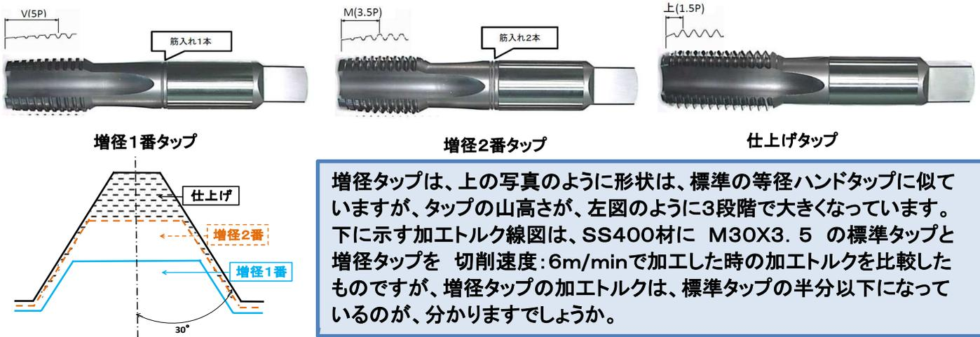
増径タップは、上の写真のように形状は、標準の等径ハンドタップに似ていますが、タップの山高さが、左図のように3段階で大きくなっています。下に示す加工トルク線図は、SS400材に M30X3.5 の標準タップと増径タップを 切削速度:6m/minで加工した時の加工トルクを比較したのですが、増径タップの加工トルクは、標準タップの半分以下になっているのが、分かりますでしょうか。
