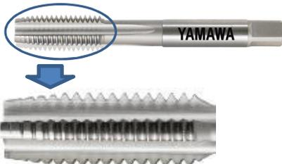
ハンドタップは、左の写真のように溝がストレートなタップです。切りくずは、比較的細くなり、通常は、溝に切りくずが收容されます。食付き部の長さにより、中タップ(5山)と上タップ(1.5山)があり、汎用的に使用されるタップです。
