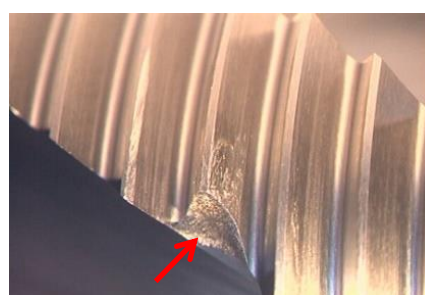
④ 完全ねじ山部に発生した「刃欠け」
