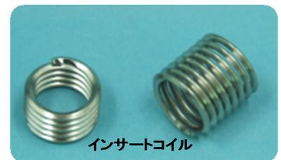
例えば、「標準タップ：HT P3 M 6X 1 5P」の 外径寸法は、約 6.000mm ですが、「インサートコイル用ハンドタップ：AL-HT 1b STI M 6X 1 5P」の 外径寸法は、約 7.299mm で、「約1.299mm」も大きくなっているんですね。
