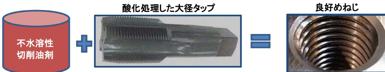
M24以下の寸法であれば、酸化処理された「ステンレス鋼用タップ」が、標準化されています。
