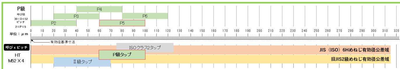
※呼び径やピッチの関係により、タップ等級の有効径公差は3種類( $15\mu m$ ・ $20\mu m$ ・ $40\mu m$ ) あります。
