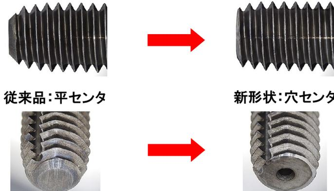
メリット: タップ先端の切り残しが無くなる事で、止り穴加工においてめねじ奥ギリギリまで加工が可能です。
