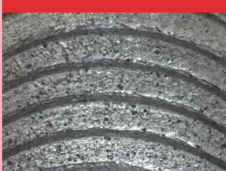
汎用タップ(コンエキセントリッククレリーフ)で、『高速加工』したことにより、発熱・溶着・切削性不足による『むしれ』が生じている。
