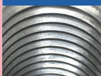
高速タップ(エキセントリッククレリーフ)で、『高速加工』すれば、発熱・溶着が抑えられ『良好なねじ』が加工できる。
