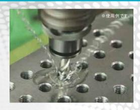
下穴精度が良好なため、安定したタッピングが行えます。
