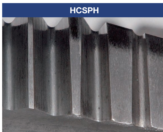
⚠ 40穴加工済み。摩耗は少なく、刃欠けなし
