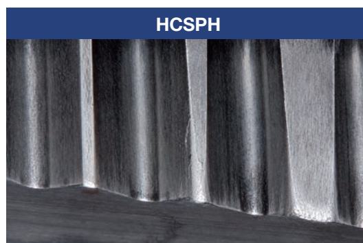
⚠ 600穴加工済み。摩耗は少なく、刃欠けなし。
