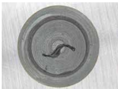
ドリルなどの切りくずが残る
