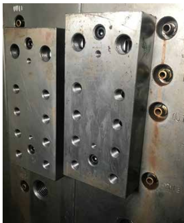
冷却穴にはたくさんのRc(PT)ねじが用いられている
