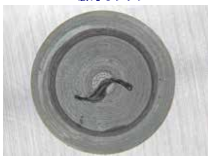
ドリルなどの切りくずが残る
