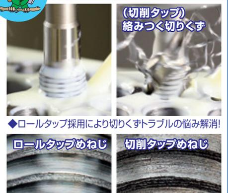
◆ロールタップ採用により切りくずトラブルの悩み解消!
