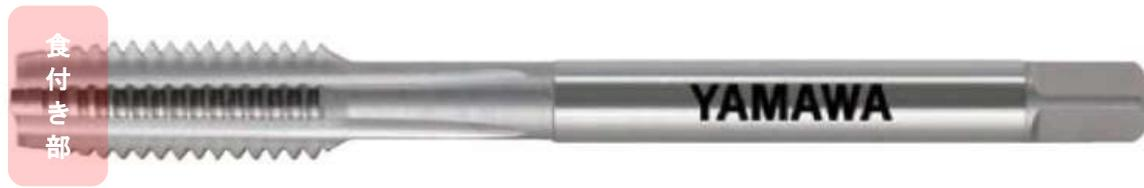
食付き部は、ねじ山を成形すると共にガイドの役目を持っています。下穴に食い付きやすくするために先端に向かって細く(テーパ)になっており、被加工材によって半径方向の逃げ角を決めています。
