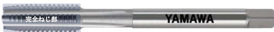
完全ねじ部は、食付き部で成形されたためねじに入り込みねじガイドの役目を行います。
