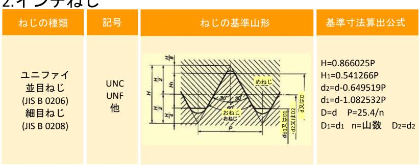
ねじの各部の寸法を25.4mm基準として決めたねじ山の角度60°の三角ねじ。
